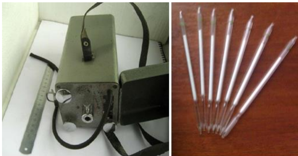
Малюнок 3. Універсальний газоаналізатор УГ-2 з колористичною лінійкою і індикаторні трубки.
