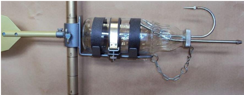
Малюнок 2. Батометр ГР-16
